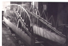
Tragflächen des „Baby III“ im Rohbau
