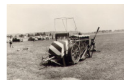
Unsere im Eigenbau angefertigte Schleppwinde
